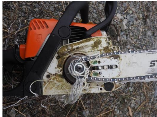
図1 繊維が絡みつきチェーンソーは停止する
